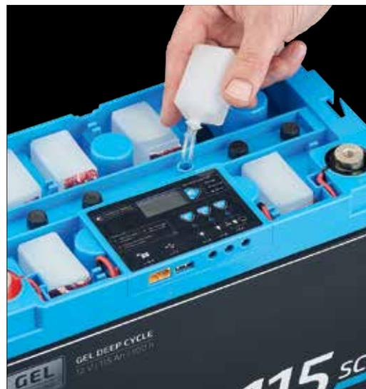
Les **recharges** intégrées sont cachées sous le boîtier bleu de certaines batteries ECTIVE AGM et gel. Même avec la technologie AGM ou gel, les batteries perdent de l'eau avec le temps. Vous pouvez contrecarrer ce processus naturel, qui se produit plus fréquemment en cas de températures élevées ou de surcharge, grâce aux recharges. Ouvrez le couvercle bleu en
