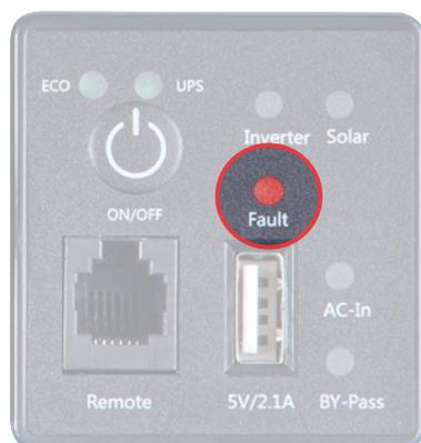
Beachten Sie im Fehlerfall die **LED „Fault“** und den Signalton, um das Problem zu identifizieren. Beheben Sie den Fehler schnellstmöglich, indem Sie die Anweisungen im Abschnitt „Fehlerbehebung“ befolgen.
