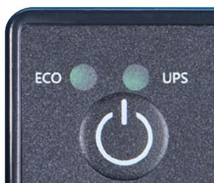
**Hauptschalter** mehrere Sekunden gedrückt halten, bis die LEDs wechseln. Dann Taste loslassen, um den Wechselrichter auszuschalten. Nur möglich, wenn kein Landstrom anliegt.
