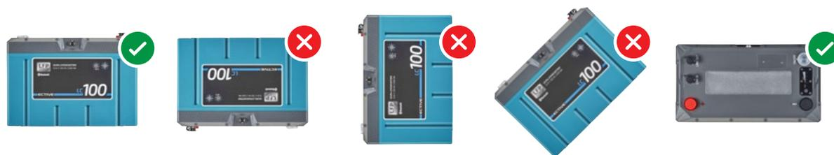
Achten Sie auf einen festen Sitz der Batterie im Fahrzeug bzw. Boot. Die **ECTIVE LC Marine 100 LT** enthält im Lieferumfang passende Montagewinkel, mit denen die Batterie auf einem sicheren, ebenen und stabilen Untergrund festgeschraubt werden kann. Befestigen Sie hierbei zunächst die Montagewinkel mit je zwei mitgelieferten Schrauben am Batteriegehäuse. Schrauben Sie anschließend die Batterie an der gewünschten Position fest.
